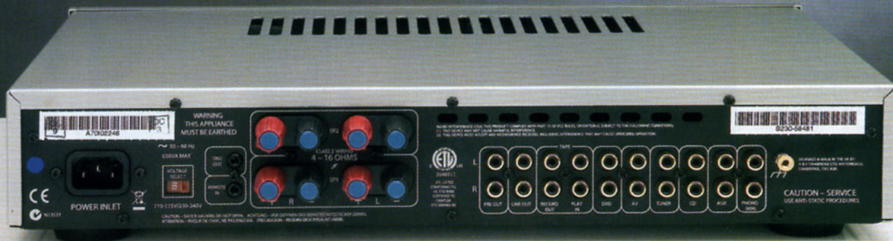
Il pannello posteriore è caratterizzato dalla presenza di un gran numero di connessioni RCA che, oltre a connettere le varie sorgenti, consentono anche la connessione di un finale all'uscita preamplificata. Inoltre è presente un'uscita denominata line out che riporta il segnale della sorgente selezionata senza interessare il volume.
